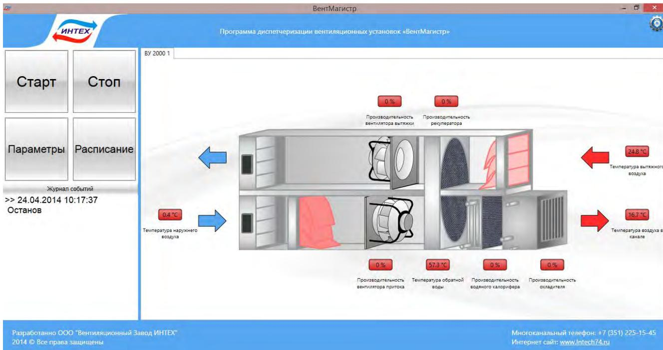
Рабочее пространство программы диспетчеризации «ВЕНТМАГИСТР»™ отличается наглядностью представления информации и интуитивно понятным интерфейсом.
