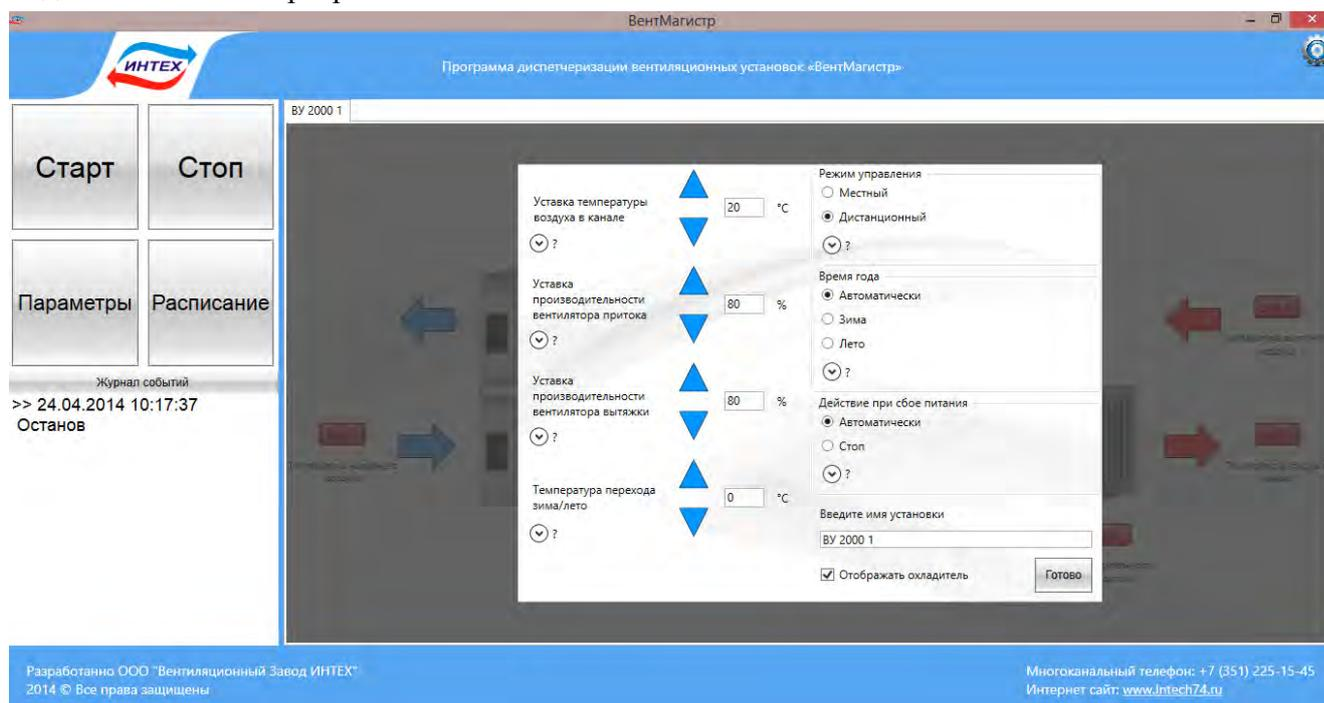
Меню «Параметры» отображает различные уставки, которые пользователь может задать для конкретного объекта и планируемых режимов работы. Каждая строка содержит всплывающую подсказку с описанием и рекомендациями завода-изготовителя относительно конкретного параметра. Кроме этого пользователь может присвоить каждому конкретному агрегату своё произвольное обозначение (по умолчанию отображается модель агрегата), например «вентиляция офиса на 1-м этаже» или «банкетный зал ресторана» и т.д.
